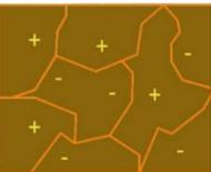
Las partículas ionizadas permanentemente, se ataran por lo que se compactan y expulsan el exceso de agua, solidificándose, mejorando el VRS del suelo tratado.
